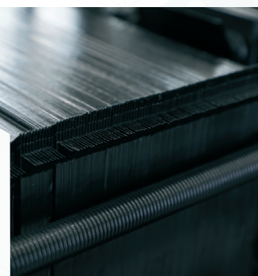
ВЫСОКОТЕХНОЛОГИЧНАЯ АНИЗОТРОПНАЯ СТАЛЬ / ШИХТОВКА STEP-LAP
