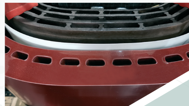
ЭЛЕКТРОСТАТИЧЕСКИЙ ЭКРАН МЕЖДУ ОБМОТКАМИ ВН И НН
