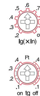
$I_g$  = Уставка защиты от замыкания на землю
