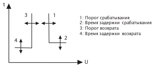
Принцип действия функции защиты от перенапряжения
