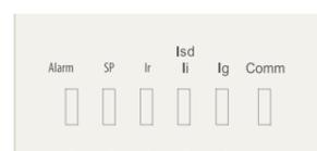
I<sub>g</sub> : индикация замыкания на землю
