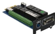
**Коммуникационная карта RELAY Card-511** обеспечивает возможность удаленного мониторинга и дистанционного включения и отключения ИБП. Релейная карта может работать как в нормально открытом (НО), так и в нормально закрытом (НЗ) режимах. Выбор режима осуществляется установкой перемычек на плате в нужное положение для каждого реле.
