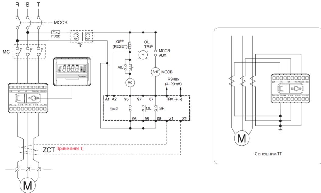
Примечание) 1. Если для обнаружения замыкания на землю используется трансформатор тока нулевой последовательности, то подключите ZCT.
