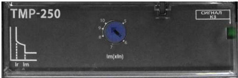
Расцепитель ТМР для защиты двигателей. Отсутствует защита от перегрузки. Стандартный диапазон регулировки электромагнитной защиты.
