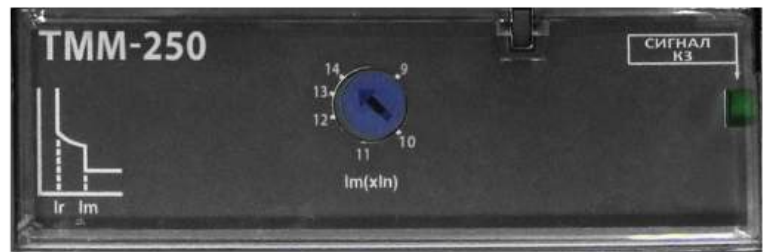
Расцепитель ТММ для защиты двигателей. Отсутствует защита от перегрузки. Высокий диапазон регулировки электромагнитной защиты.
