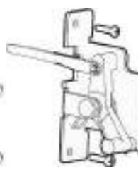
Блокировка от извлечения АВ в положении «вкл»
