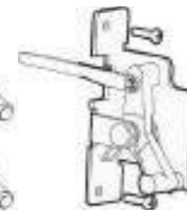
Блокировка от извлечения АВ в положении «вкл»
