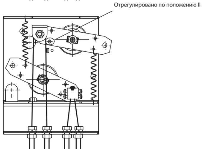
Два блокировочных стержня (один для замыкания, один для размыкания).
