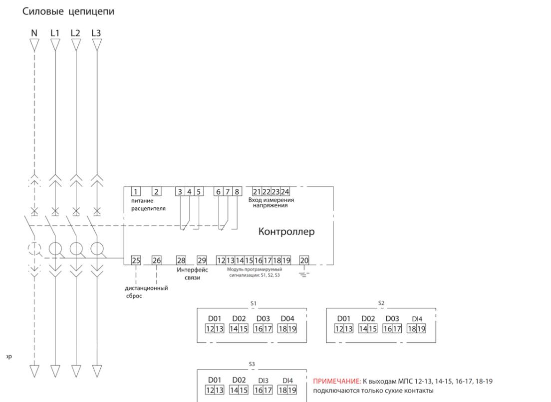
12,13 — сигнальный контакт 1, нагрузочная способность контакта: 250 В перем. тока/5 А; НО В пост. тока/0,5 А, дополнительная функция;
