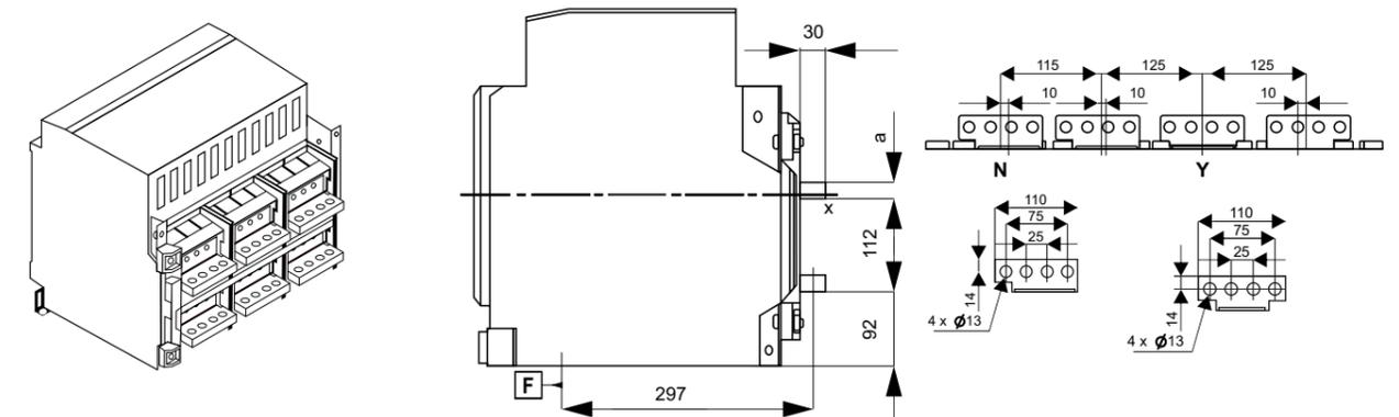
**ВГУ-ГОРИЗОНТАЛЬНОЕ ПОДКЛЮЧЕНИЕ ВЫКАТНОГО ТИПА, УДЛИНЕННЫЕ ВЫВОДА**
