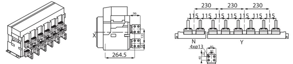
**ГОРИЗОНТАЛЬНОЕ ПОДКЛЮЧЕНИЕ ВАВ-Р 6300AF ВЫКАТНОГО ТИПА 4000А-5000А**
