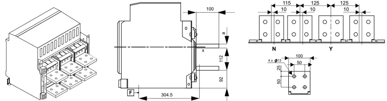
**ВГ-ГОРИЗОНТАЛЬНОЕ ПОДКЛЮЧЕНИЕ ВЫКАТНОГО ТИПА**
