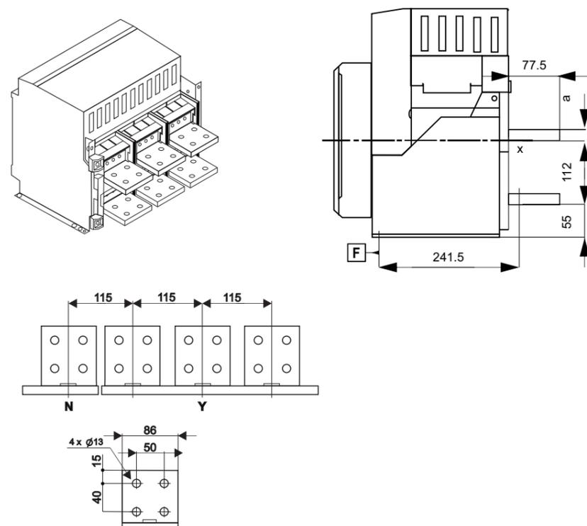
**ГАБАРИТНЫЕ РАЗМЕРЫ ВАВ-Р 3200AF ВЫКАТНОГО ТИПА**
