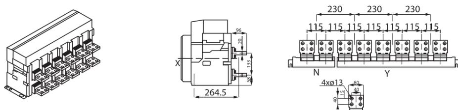
**ВЕРТИКАЛЬНОЕ ПОДКЛЮЧЕНИЕ ВАВ-Р 6300AF СТАЦИОНАРНОГО ТИПА 4000А-5000А**
