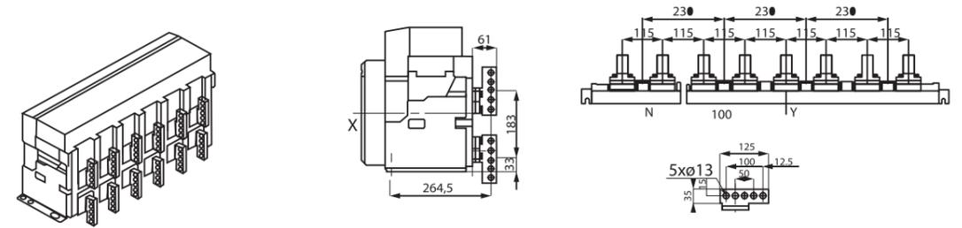
ГАБАРИТНЫЕ РАЗМЕРЫ ВАВ-Р 6300AF ВЫКАТНОГО ТИПА(ММ)
