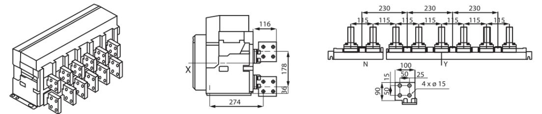
ВЕРТИКАЛЬНОЕ ПОДКЛЮЧЕНИЕ ВАВ-Р 6300AF ВЫКАТНОГО ТИПА 6300А
