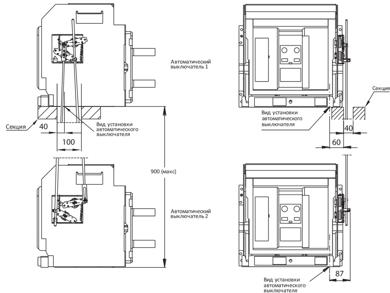
Три блокировочных стержня (один для замыкания, два для размыкания)
