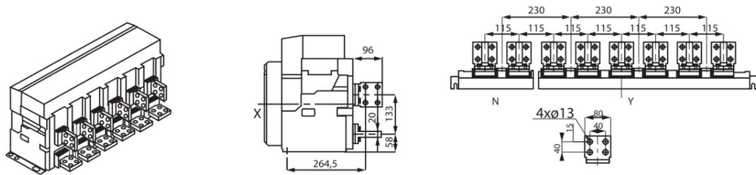
ВЕРТИКАЛЬНОЕ ПОДКЛЮЧЕНИЕ ВАВ-Р 6300AF СТАЦИОНАРНОГО ТИПА 6300А
