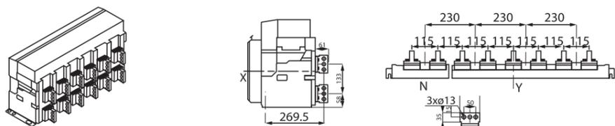
**ГОРИЗОНТАЛЬНОЕ ПОДКЛЮЧЕНИЕ ВАВ-Р 6300AF СТАЦИОНАРНОГО ТИПА 4000А-5000А**
