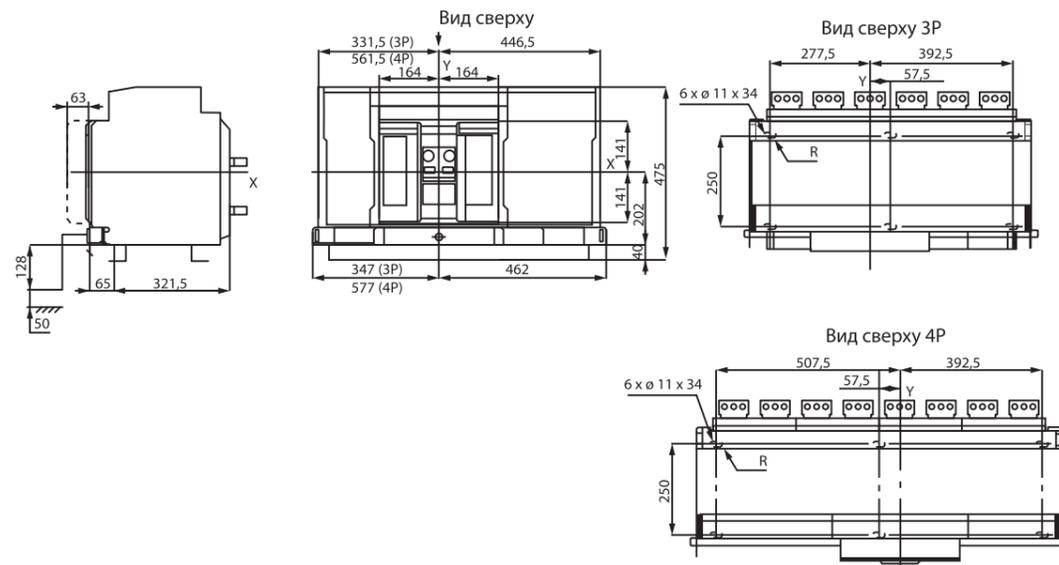
ВЕРТИКАЛЬНОЕ ПОДКЛЮЧЕНИЕ ВАВ-Р 6300AF СТАЦИОНАРНОГО ТИПА
