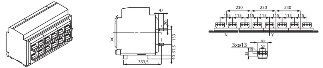
**ВЕРТИКАЛЬНОЕ ПОДКЛЮЧЕНИЕ ВАВ-Р 6300AF ВЫКАТНОГО ТИПА 4000А-5000А**
