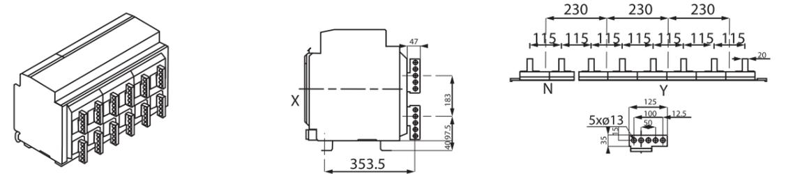
ВЕРТИКАЛЬНОЕ ПОДКЛЮЧЕНИЕ ВАВ-Р 6300AF ВЫКАТНОГО ТИПА 6300А
