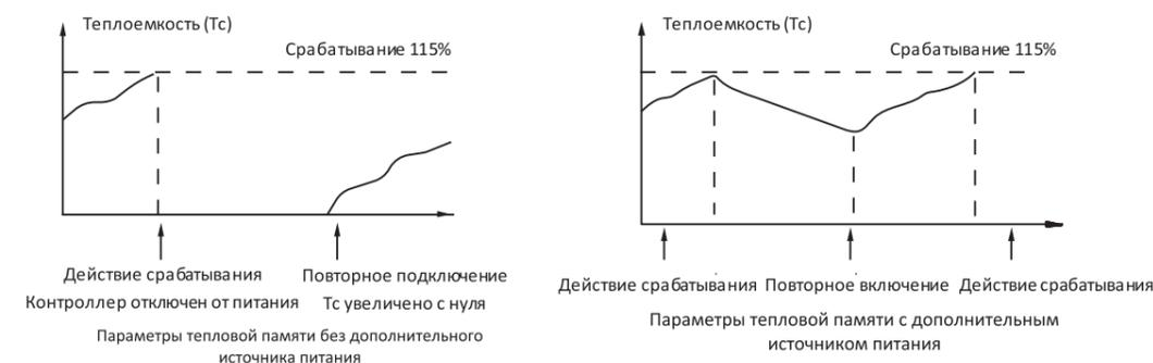
Сигнализация о перегрузке, параметры тепловой памяти с дополнительным источником питания. Функция сигнализации о перегрузке в основном используется для контроля нагрузки и отправления сигналов тревоги о перегрузке в случае превышения допустимого значения тока (задаётся уставкой).
