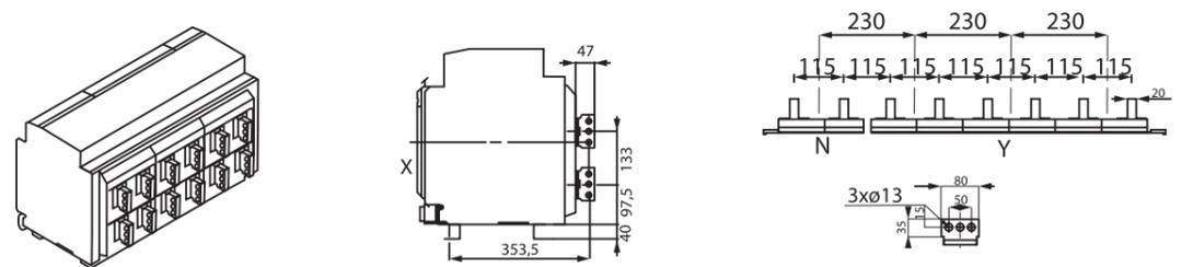
**ГОРИЗОНТАЛЬНОЕ ПОДКЛЮЧЕНИЕ ВАВ-Р 6300AF ВЫКАТНОГО ТИПА 4000А-5000А**
