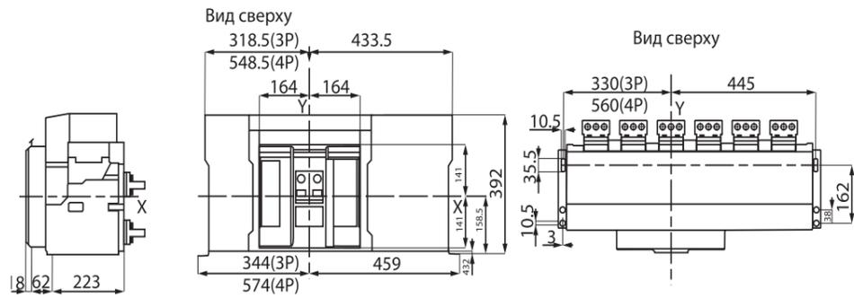
**ГОРИЗОНТАЛЬНОЕ ПОДКЛЮЧЕНИЕ ВАВ-Р 6300AF СТАЦИОНАРНОГО ТИПА 4000А-5000А**
