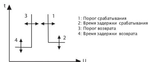
Принцип действия функции защиты от перенапряжения
