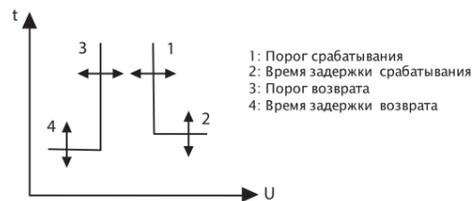
Принцип действия функции защиты от перенапряжения
