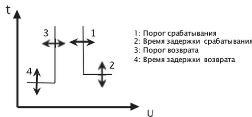
Принцип действия функции защиты от перенапряжения
