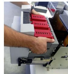
Берёмся за ручки на выключателе и снимаем его с направляющих вертикально вверх
