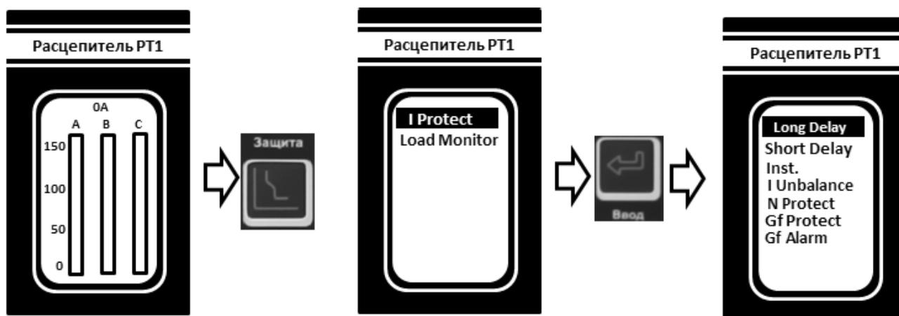
В разделе меню "Long Delay" (токковая защита с длительной выдержкой времени) можно задать параметры рабочего тока  $I_r$ , выбрать тип кривой срабатывания "Curve Type", задать время срабатывания  $T$ , задать выдержку времени на повторное включение выключателя после срабатывания защиты "Cooling Time", включить и отключить сигнализацию о перегрузке "Alarm I".
