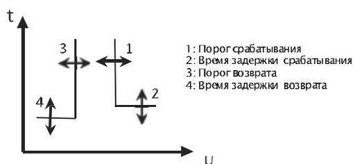
Принцип действия функции защиты от перенапряжения
