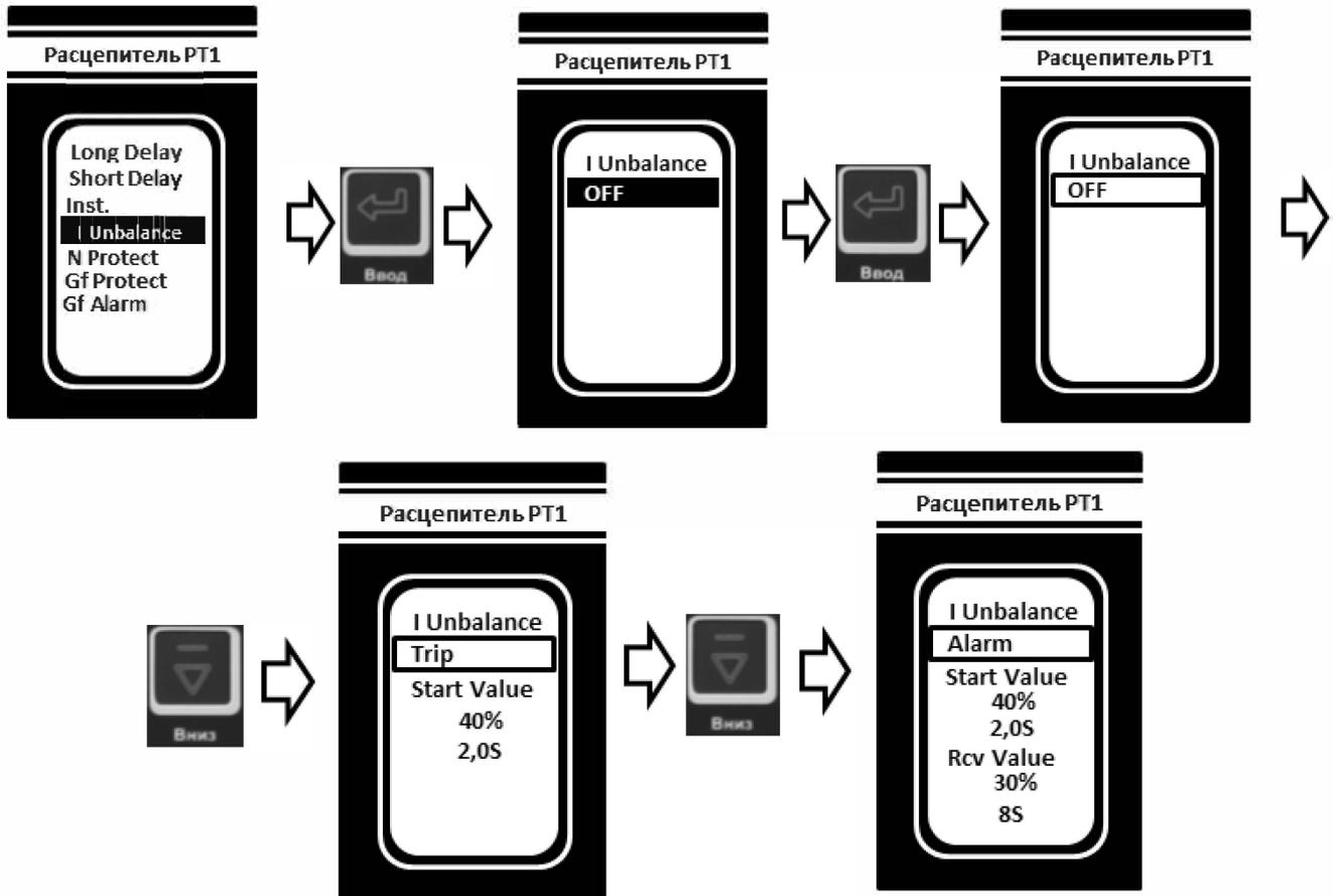
В режиме работы защиты "I Unbalance" на отключение выключателя "Trip" вы можете задать допустимый уровень небаланса по току (при превышении заданного значения произойдет отключение АВ) и время срабатывания защиты.
