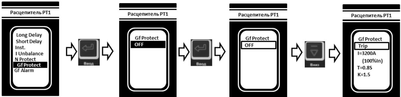
В разделе меню "Gf Alarm" (сигнализация от замыкания на землю) можно выбрать 2 режима работы:
