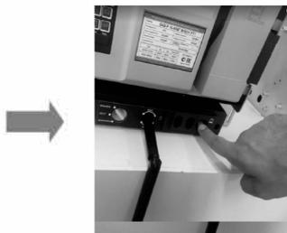
Вставляем рукоятку в гнездо привода и зажимаем блокировку
