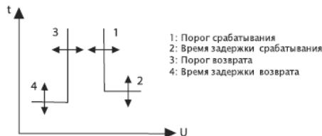
Принцип действия функции защиты от перенапряжения
