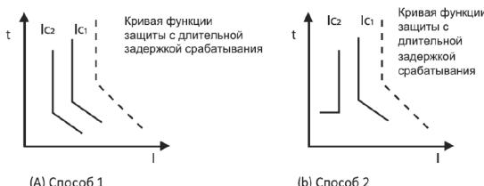
Режимы и параметры срабатывания функции контроля нагрузки по току
