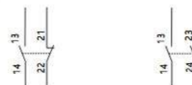
Контакт сигнализации аварийного срабатывания и вспомогательный контакт (контакты 01 - контакты аварийного срабатывания; контакты 10 — вспомогательные контакты)
