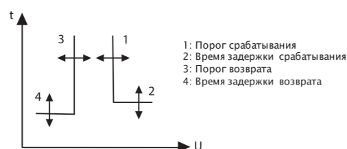
Принцип действия функции защиты от перенапряжения
